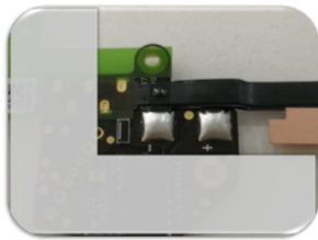
电池汇流排 Battery bus bar
